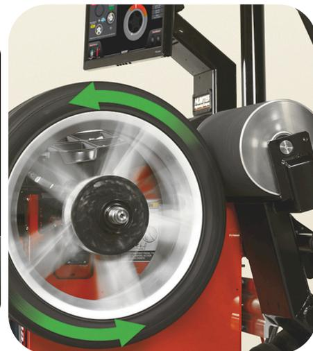
Analizamos la llanta y rin por computadora, con láser se escanea el rin y un rodillo aplica fuerza para simular su funcionamiento en condiciones reales. Este sistema nos da dos beneficios:
